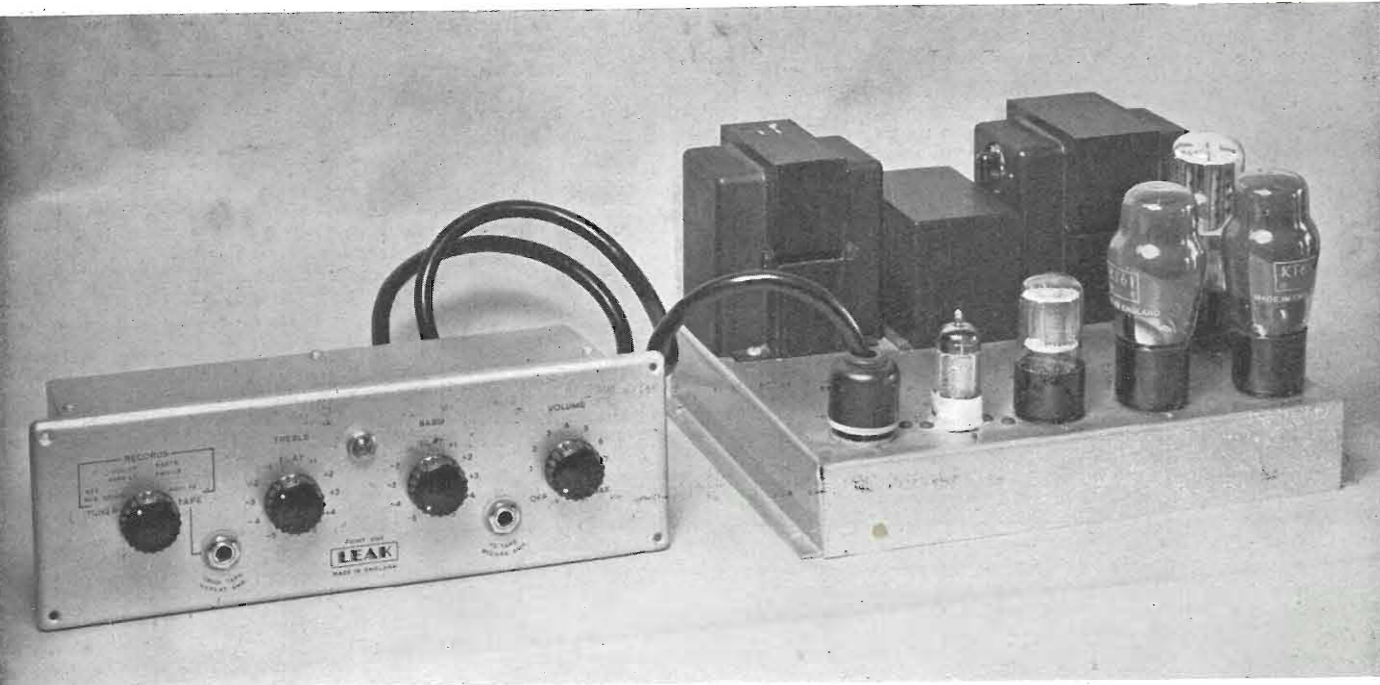
Fig. 3 - Il preamplificatore Leak Point-One e l'amplificatore TL/10 con il cavo di interconnessione. Da sinistra a destra i comandi: il selettore d'ingresso, le regolazioni degli acuti, dei bassi e del volume, comprendente l'interruttore generale.
